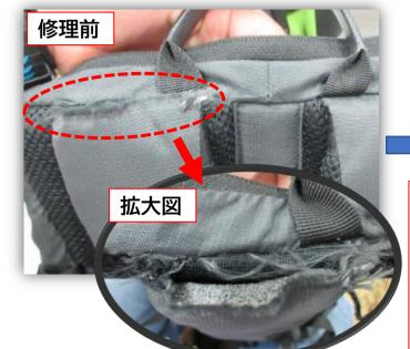
バックパックのショルダーハーネスの 縫製滑脱になります。縫い込んで縫製 するため、若干生地がヨレて、ショル ダーハーネスの長さが短くなる場合が あります。また、その場合には左右の 長さを調整して修理します。
